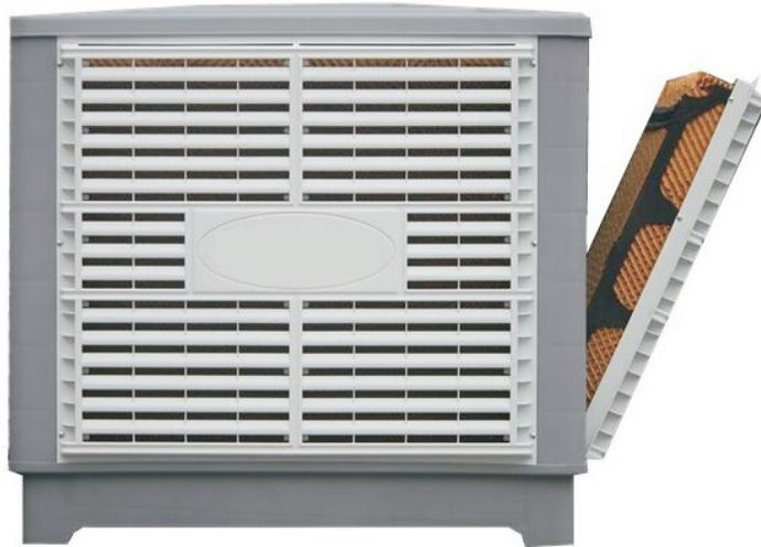
Desconecte la alimentación, desatornille los 6 tornillos en la parte superior de las contraventanas con un destornillador, sostenga la parte superior de las contraventanas y tire ligeramente hacia arriba (ligeramente levantado) para quitar los componentes de la almohadilla mojada.
